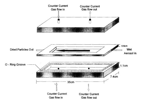
Fig. 1. The flat sheet membrane mount.
